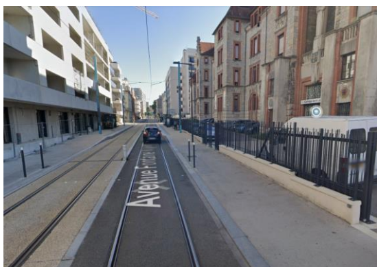
Zone 30 Avenue Fontaine-Argent Besançon Voie banalisée dans un sens de circulation
